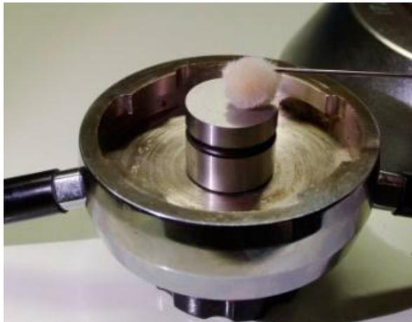
8.7.8 Нажмите клавишу START в области автоматического управления, после чего машина перейдет в автоматический режим работы. Нагрев и прессование будут производиться одновременно.
