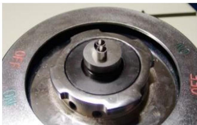
8.7.6 Засыпьте смолу в пресс-форму. Удобно использовать для этого специальную мерную ложечку-стаканчик. Если требуется засыпка сразу нескольких типов смол, то перед засыпкой второго слоя, рекомендуется шпателем слегка разровнять первый слой.
